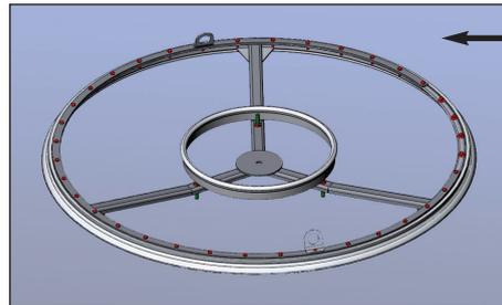
**LE TAMIS** est constitué par un châssis circulaire, démontable rapidement, sur lequel la toile de tamisage est soit bridée, soit collée, selon l'ouverture de la maille et le matériau à tamiser. Le changement de toile peut être réalisé sur le lieu d'exploitation.
